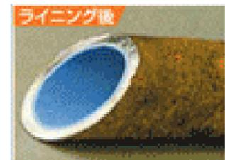
既設管の内面に膜を形成することにより気密性を確保する工法
