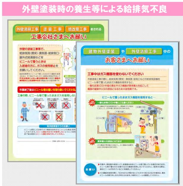
外壁塗装時の養生等による給排気不良
