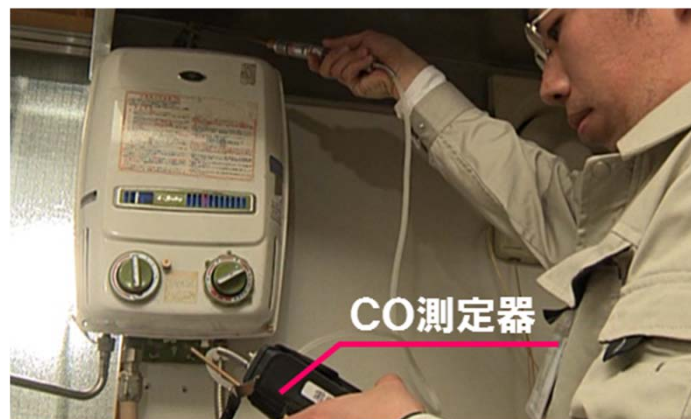
小型湯沸器の一酸化炭素測定
