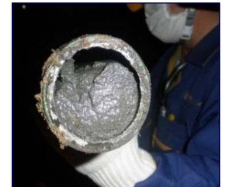
図 東日本浦安市での供給停止状況（京葉ガス）
