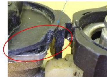
ガス栓の変形部分
