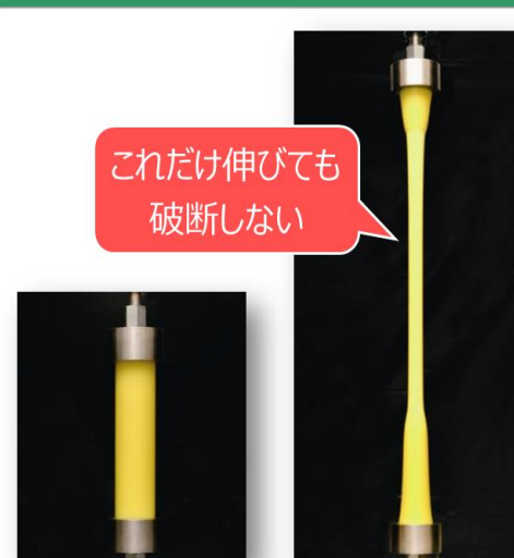
ポリエチレン管の引張試験
