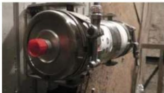
発火源試料と迎爆試料の ノズル同士を近接
