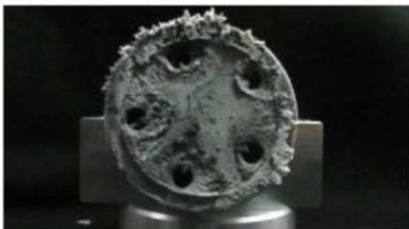
【試験後の迎爆試料（ノズル側）】
