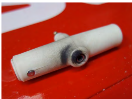
3 回目試験結果(伝火なし、外郭に破損なし)
