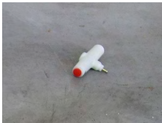
試験結果(爆発、点火、外郭の損傷なし)
