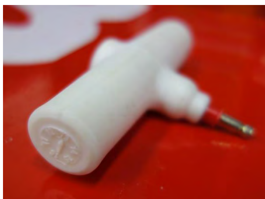
試験結果(爆発、点火、外郭の損傷なし)
