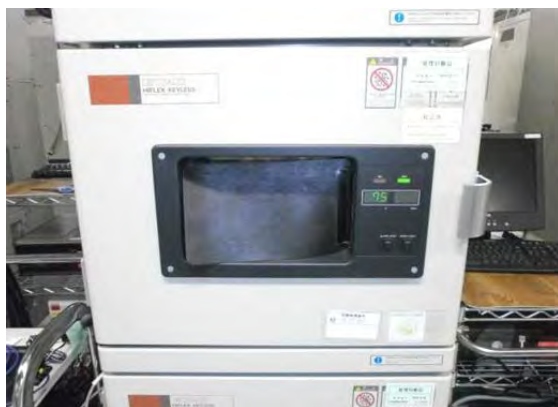
恒温恒湿試験器(ETAC製 TH403H)
