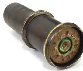
写真 2. 導管に固定された火薬カートリッジ
