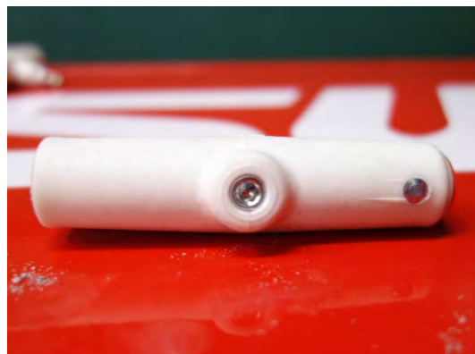
2 回目試験結果 (伝火なし、外郭に破損なし)
