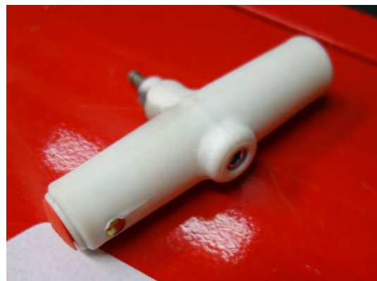
1 回目試験結果(伝火なし、外郭に破損なし)
