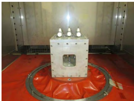
前後方向の振動試験
