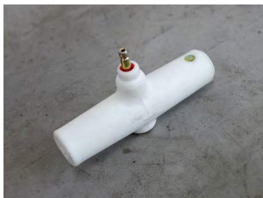
試験結果(爆発、点火、外郭の損傷なし)
