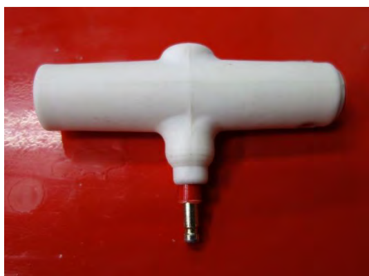
試験結果(爆発、点火、外郭の損傷なし)
