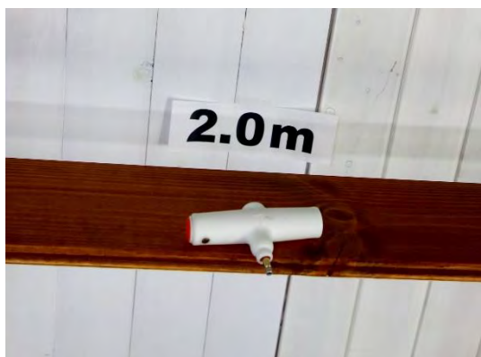
落下試験装置に設置された供試火工品
