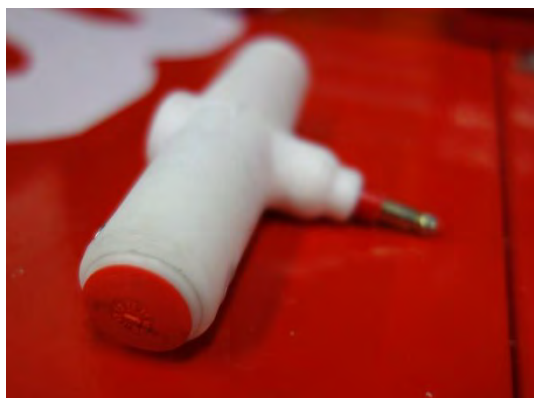
試験結果(爆発、点火、外郭の損傷なし)
