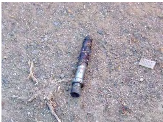
飛散物（接続金具導管）
