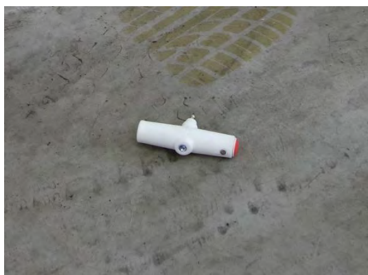
試験結果(爆発、点火、外郭の損傷なし)
