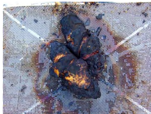
試験終了後の供試火工品
