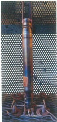
水平にセット: グリッド面(金網)に、熱損失が少ない針金で固定
