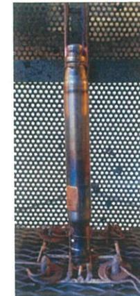
垂直にセット: インフレータの上側と下側を、熱損失が少ない針金で固定
