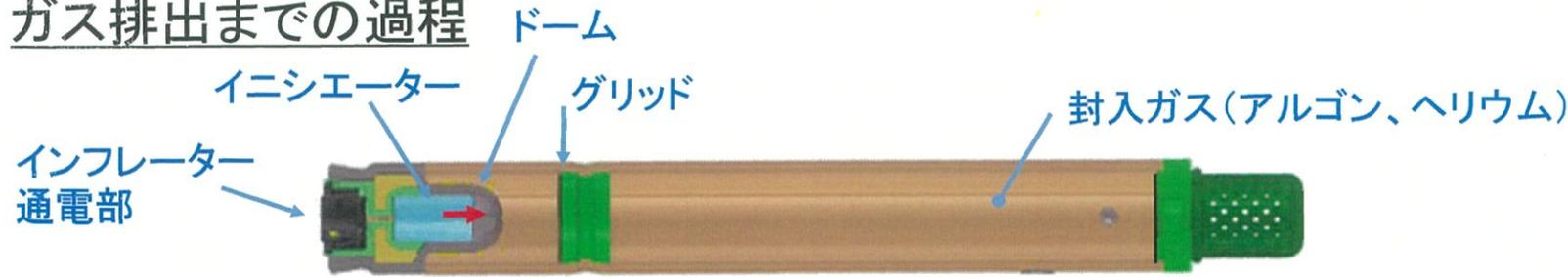
インフレーター通電部への電気信号でイニシエーターが着火し、発生するガスがドーム内の圧力を上昇させます。
