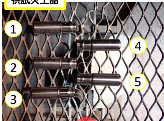
通常の運搬時において隣接する可能性のある数の供試火工品を金網上に並べ、下方からガスバーナーを用いて、供試火工品全体を火炎が包むように試験する
