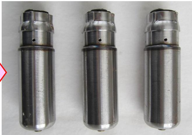
一連の環境条件(加熱試験、振動試験、落下試験)を同一の供試火工品に印加し、通常点火試験で問題なく正常に作動したことから、いずれの判定基準も満たしており、問題ないと判断する
