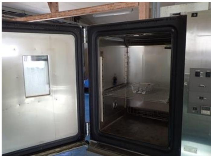
供試火工品を、 $75\pm 2^{\circ}\text{C}$ の温度制御機能のある循環式恒温槽に入れ、48時間加熱する
