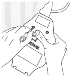
図12: 蓋を元に戻し、ネジをガスインフレーター収納部(2)にしっかりと差し込みます。
