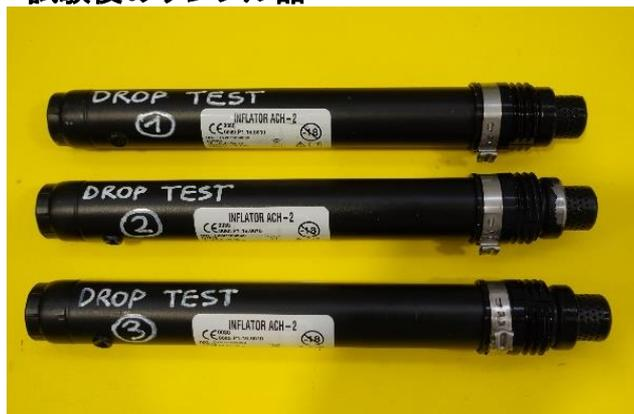
落下による発火や外殻の破損等の損傷はない。
