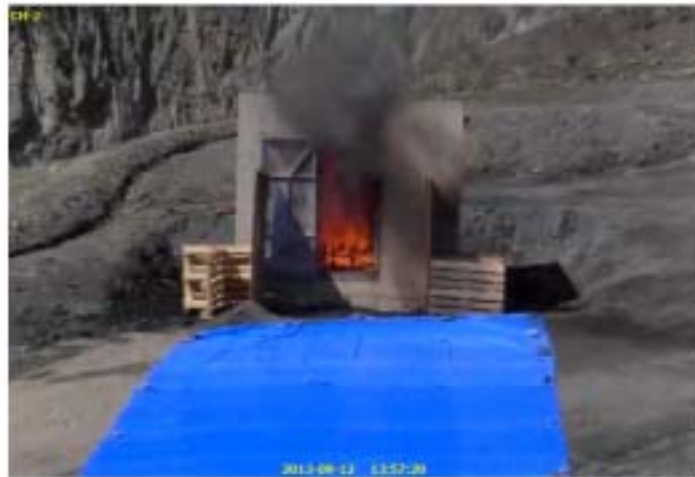
図 2-8 内部模擬火災の様子
