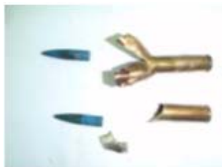
図 1-1-8 270WIN (実験 3 回目、発火は加熱中1個、消火開始後1個が破裂した。)
