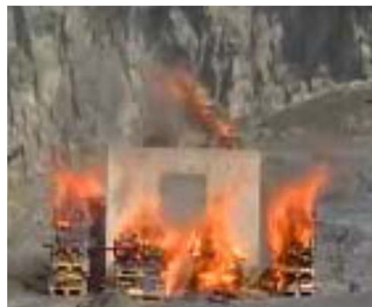
図 2-6 薪による外部模擬火災状況
