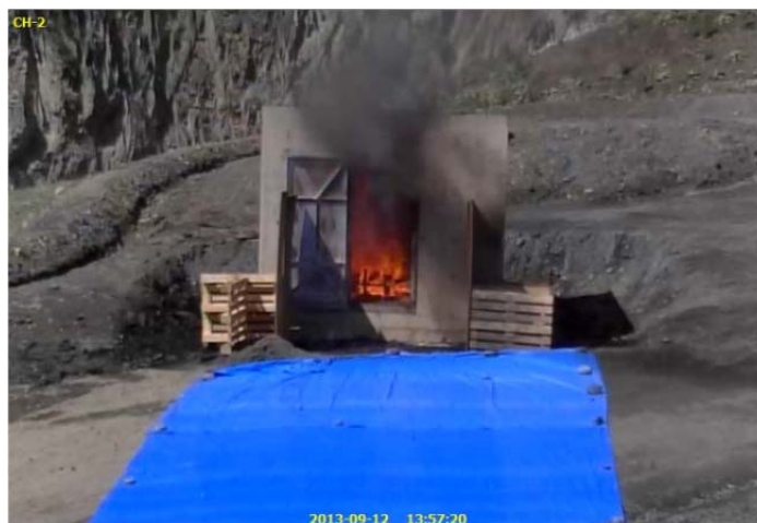
図 2-8 内部模擬火災の様子
