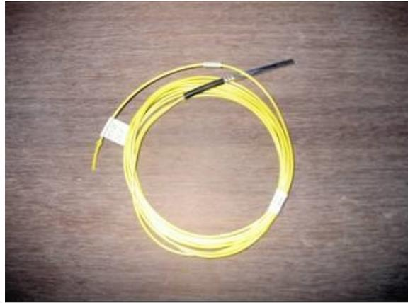
写真-2 非電気式雷管
