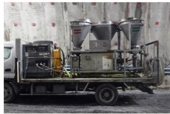
写真-2 ランデックス装填機
