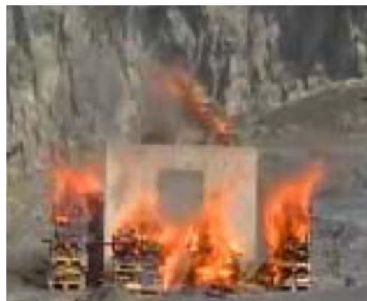
図 2-6 薪による外部模擬火災状況
