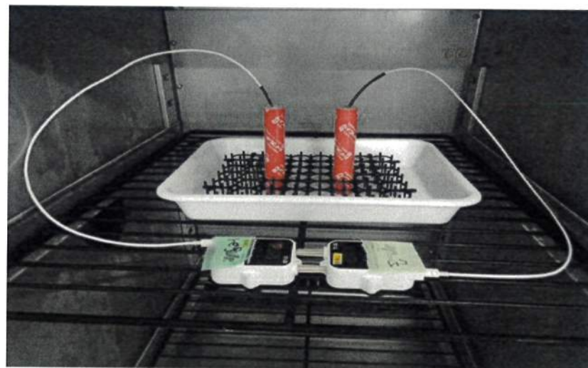
発炎剤内部に熱電対を挿入し温度測定 写真左：発炎剤開発品 (特則) 写真右：発炎剤承認品
