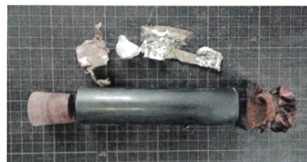
起爆感度試験後の試料写真
