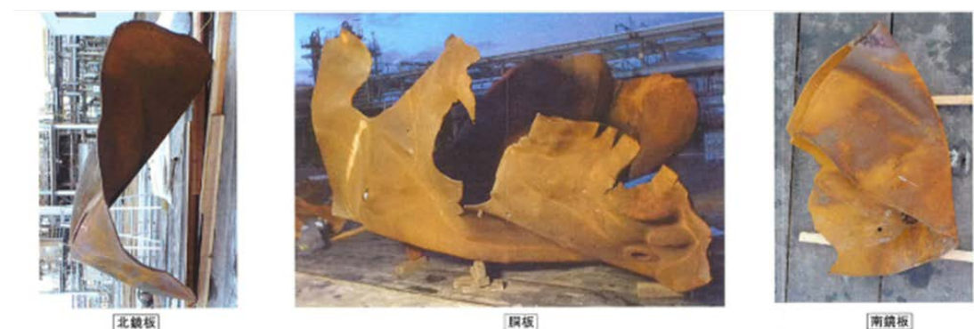
写真 3 塩酸塔還流槽の破壊状況
