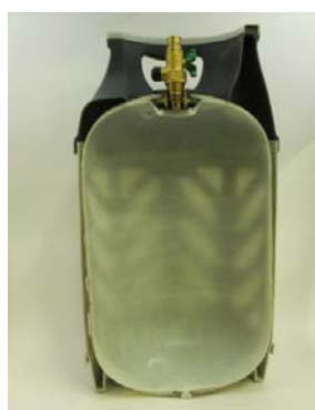
図3 LPガス用複合容器（7.5kg型容器）の断面
