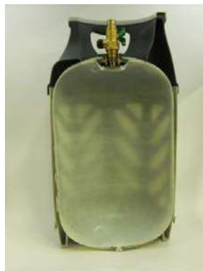
(左) 鋼製の溶接容器 (8kg型容器、容器だけの質量は9.6kg)、(中) 複合容器 (7.5kg型容器、容器だけの質量は4.4kg)、(右) LPガス用複合容器 (7.5kg型容器) の断面 (写真提供：中国工業株式会社)
