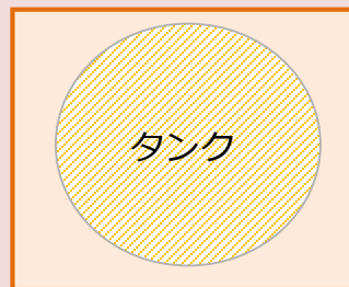
従来の防爆エリア（橙） 見直し後の 防爆エリア（黄）
