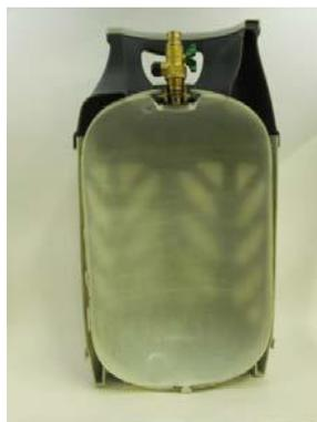
(左) 鋼製の溶接容器 (8kg型容器、容器だけの質量は9.6kg)、(中) 複合容器 (7.5kg型容器、容器だけの質量は4.4kg)、(右) LPガス用複合容器 (7.5kg型容器) の断面
