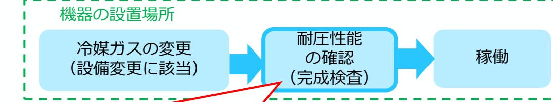
設置場所での耐圧試験は困難であるため、耐圧性能の確認方法として、変更後の冷媒ガスの物性と、機器製造時の耐圧試験結果等を比較して、安全性を確認。
