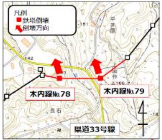
鉄塔の倒壊方向
