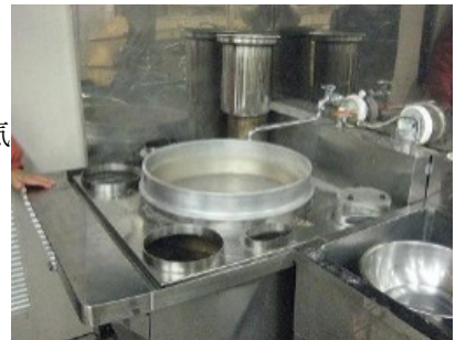
※（再現写真）排気口を鍋のようなもので閉塞した状態
