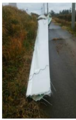
平成27年12月 福井県 ブレード（翼）折損事故
