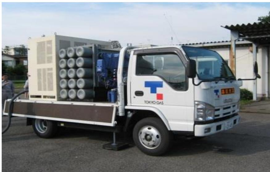
移動式ガス発生設備の例（圧縮ガス）
