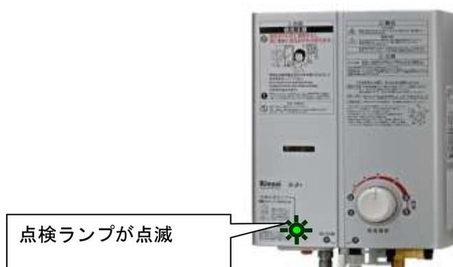
※使用回数や使用時間などにより、使用年数を推計し、使用時間が設計標準使用期間を過ぎると当該製品の表示部にランプを点滅させるなどして、所有者に対して点検時期の到来の目安を知らせる。メーカー等の点検員のみがリセットできるようにし、その際に、所有者に対し点検を促す。
