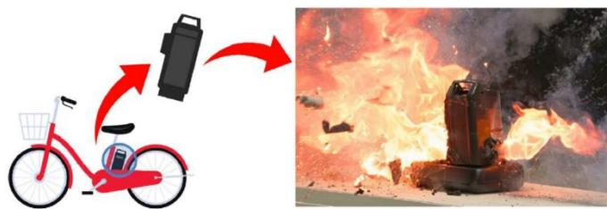
電動アシスト自転車用非純正バッテリーから発火する様子（再現イメージ映像）
