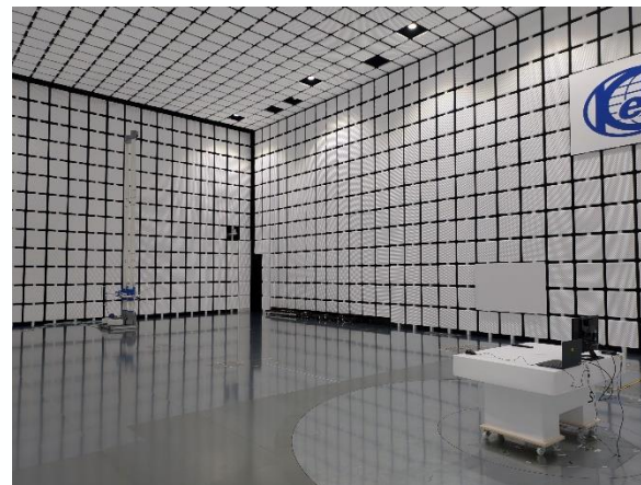
雑音の強さを測定する電波暗室
