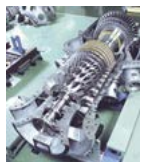
水素ガスタービン
