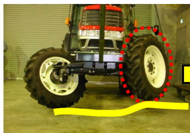
右切り、左タイヤ上がり(凸凹面での旋回時)
