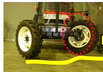
左切り、左タイヤ上がり(凸凹面での旋回時)
