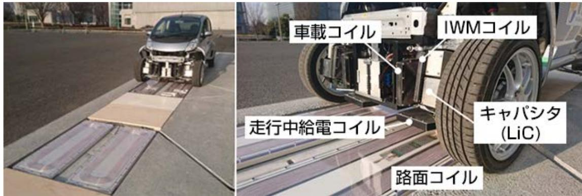
図1 走行中給電を行なう「第2世代ワイヤレスインホイールモータ」
