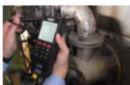
Fig.5 ガス焼成炉バーナーの 空気比管理
