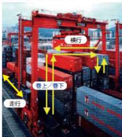
Fig.25 トランスファークレーン
