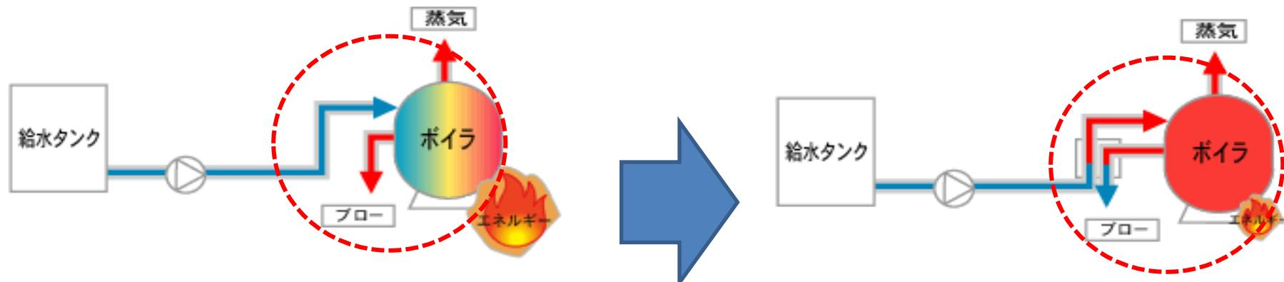
ブロード排水とボイラ給水の間で廃熱を回収。
