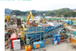
Fig.6 被災地で稼働する二輪せん断式破碎機
