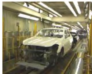
洗浄されたボディに電着,中塗,上塗を焼付け塗装する。
