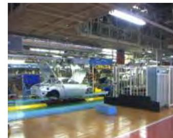
エンジン,ミッション,シート,計器類,バンパー,窓ガラスなど内外装部品を取り付ける。
