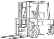
フォークリフトは、工場、倉庫、物流センター、港湾等の幅広い場所で、荷の搬送や荷役を行う車両であるが、ガソリンや軽油を燃料源とするエンジン式から、蓄電池を搭載し、電気をエネルギー源として稼働する電動式に切り替えることにより、使用段階での CO2 排出量を大幅に削減することが可能で、フォークリフトを利用している多くの産業界における低炭素化に貢献する。
