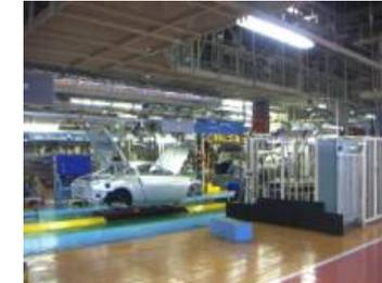
エンジン、ミッション、計器類、バンパー、駆動用バッテリーなど内外装部品を取り付け
