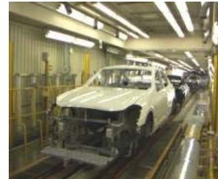
洗浄されたボディに電着、中塗、上塗を焼付ける
