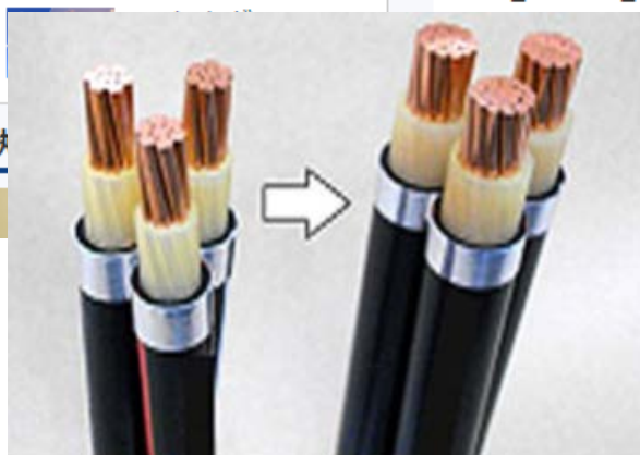
(図2) 写真は38mm 2 →100mm 2 のサイズアップ例 (导体断面積2.6倍、ケーブル外径1.5倍) 出典：日本電線工業会
