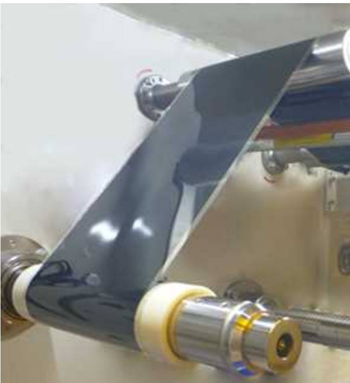
ロールtoロールによる製造
