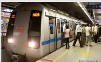
デリー高速輸送システム建設事業 電力回生ブレーキ採用による省エネ効果(インド)(有償)
