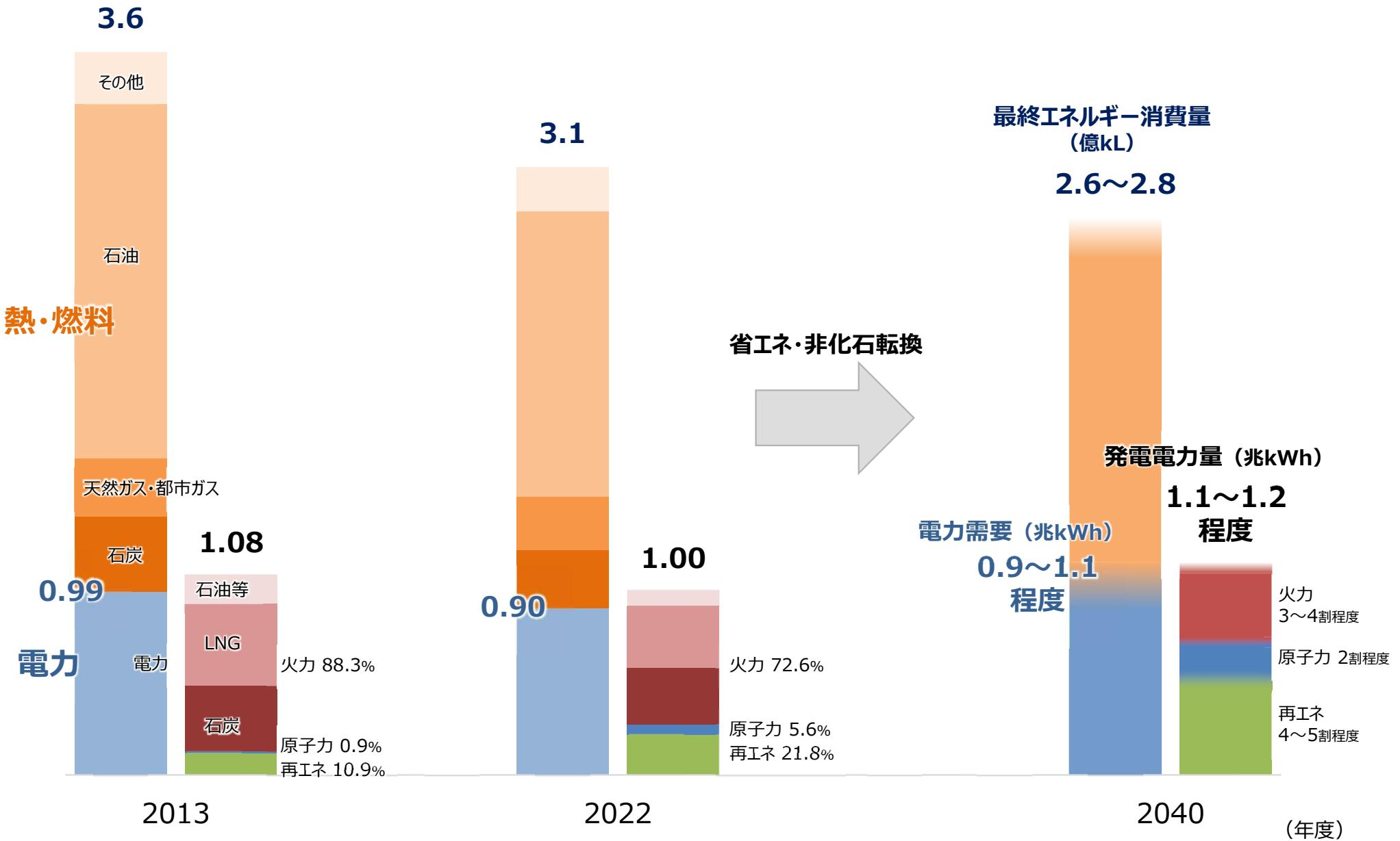
（注）左のグラフは最終エネルギー消費量、右のグラフは発電電力量であり、送配電損失量と所内電力量を差し引いたものが電力需要。
