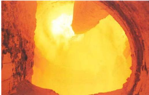
クリンカ焼成中の回転窯の内部
