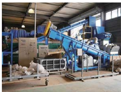
自社リサイクルセンター内に設置した RPF 成型ライン
