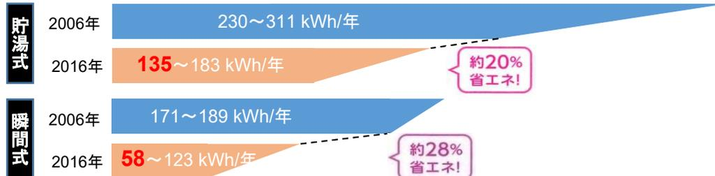
貯湯式：タンクの中の水をヒーターで温める方式で、一度にたっぷりの温水で洗浄することができますが、温水を保温するための電力が必要。
